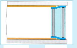
sigillatura tratti lunghi, risanamento crepe longitudinali, protezione anti-corrosione per condotte con fluidi aggressivi
